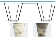
Gleichmäßige und langlebige Oberflächenbeschichtung (nach 10 Stunden Buxbaum trimmen, links mit, rechts ohne Beschichtung)
