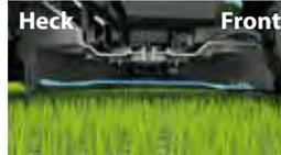
Die Klinge neigt sich nach der Montage leicht um doppeltes Schneiden zu verhindern und den Stromverbrauch so zu reduzieren.
