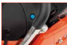
Geringerer Kraftaufwand beim Starten durch Dekompressionsventil .
