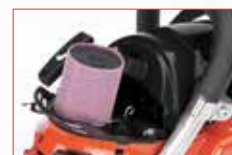
HD-Filter für den Einsatz unter extrem staubigen Verhältnissen.
