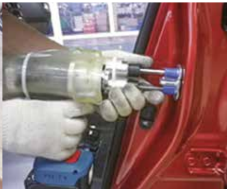
Installation von Türschließern
